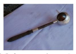
yang berukuran kecil. Secara umum ukuran *canting* berdiameter 7--9 cm. Pada bagian sisi atau badan *canting* tersebut diberikan tongkat yang berbahan kuningan, perak, atau kayu yang berfungsi untuk memegang *canting* pada saat difungsikan. Pada bagian sisi lainnya juga terdapat lubang dengan saluran berupa pipa kuningan, perak, atau bambu dengan ukuran kecil untuk tempat keluarnya air pada saat *canting* difungsikan.
