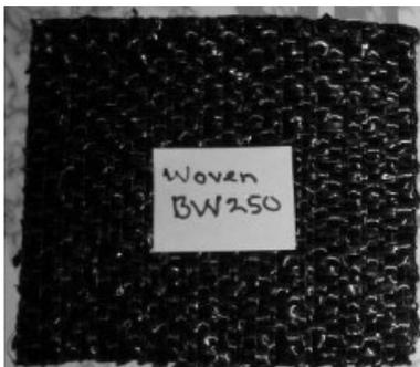
**Gambar 3.** Geotekstil yang digunakan Geotekstil BW-250 dengan *tensile* sebesar 55 kN/m.
