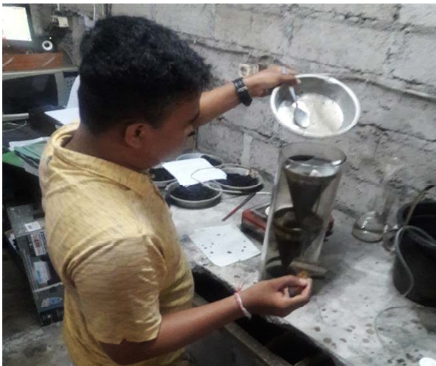
Lampiran F15: Sampel dan pelarut dimasukkan ke dalam tabung dan akan mulai ekstraksi sampai pelarut berwarna jernih
