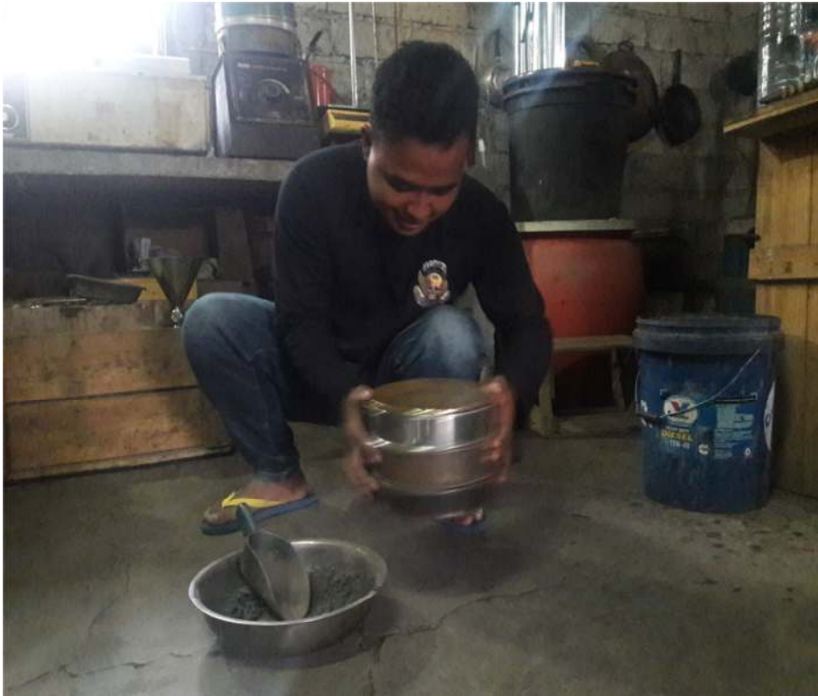
Lampiran F18: Hasil Ekstraksi diayak untuk memisahkan agregat kasar dan agregat halus
