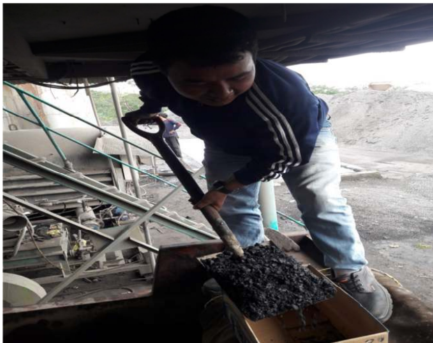
Lampiran F2: Pengambilan Sampel Aspal di AMP
