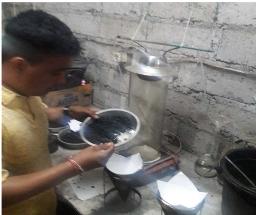
Lampiran F13: Sampel dimasukkan ke keranjang alat pengujian
