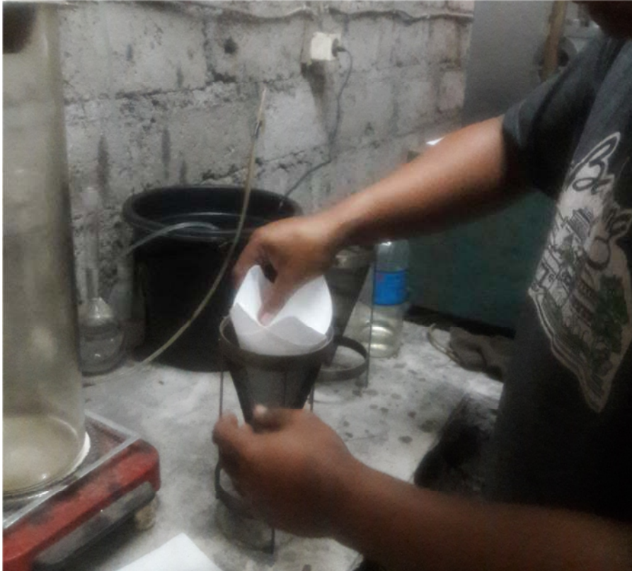
Lampiran F12: Kertas saring dibentuk kerucut dan dimasukkan ke keranjang kerucut
