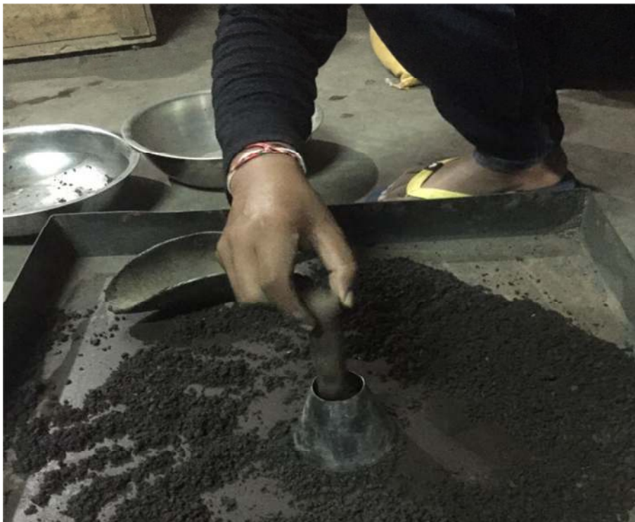
Lampiran F21: Agregat dimasukan kedalam kerucut lalu ditumbuk
