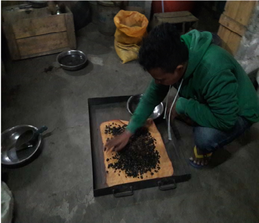
Lampiran F20: Agregat dikeringkan untuk mencari kering permukaan (SSD)
